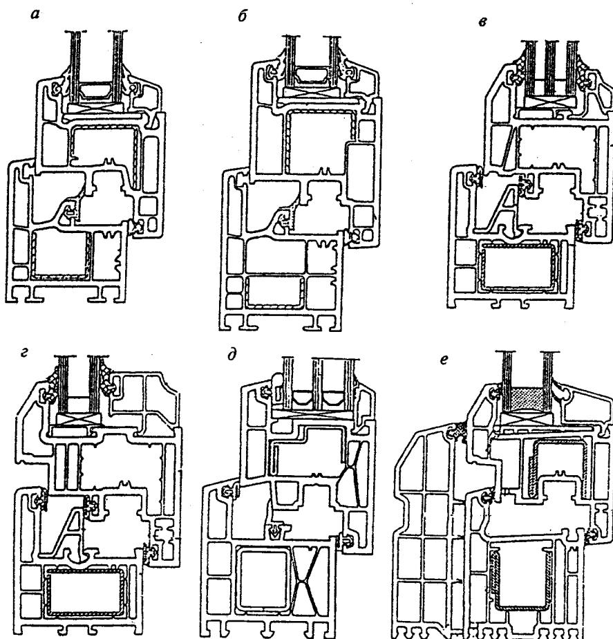
*a, б - оконные системы из трехкамерных профилей со средним и внутренним уплотнениями; в - оконная система с четырехкамерной створкой и трехкамерной коробкой, с наружным, средним и внутренним уплотнениями; г - оконная система с многокамерной створкой и трехкамерной коробкой с наружным, средним и внутренним уплотнениями (расположение лицевых наружных стенок створок и коробок в одной плоскости);*
