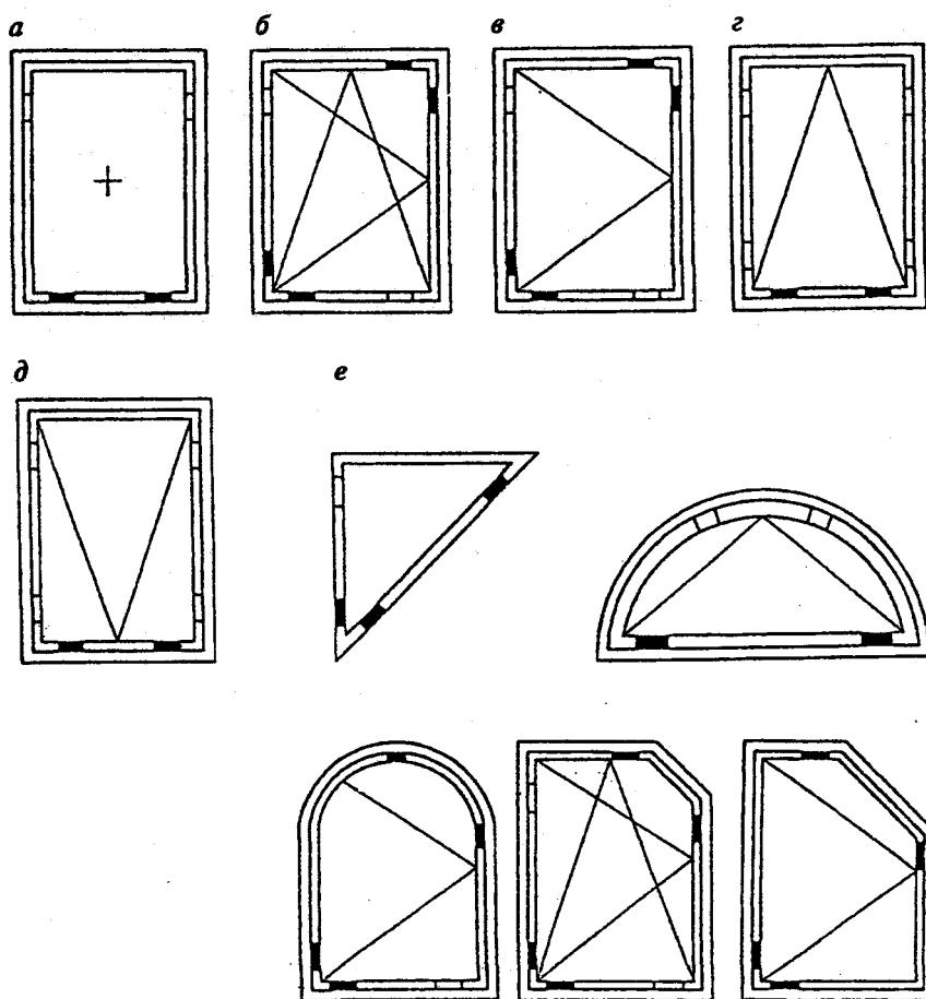
Виды открывания оконных блоков: а — неоткрывающиеся; б — pivotно-откидное; в — pivotное (распашное); г — откидное; д — подвесное; е — установка подкладок в фигурных оконных блоках
