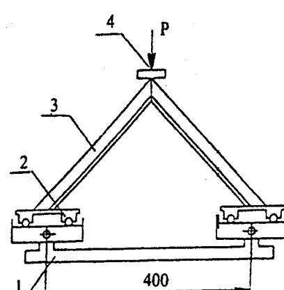
/ — опора; 2 — упор (для схемы Б — каретки); 3 — образец; 4 — точка приложения нагрузки; 5 — съемные хомуты крепления
