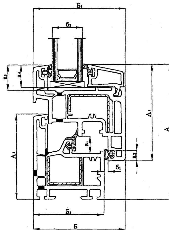
А — высота комбинации профилей; А<sub>1</sub> — высота профиля створки; А<sub>2</sub> — высота профиля коробки; Б — ширина комбинации профиля; Б<sub>1</sub> — ширина профиля створки;
