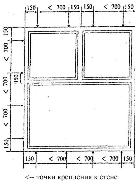
Рисунок Г.3 — Расположение крепежных деталей
