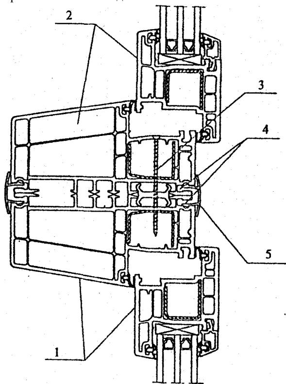
/ ~ оконный блок; 2 — дверной балконный блок; 3 — стяжной шурп; 4 — силиконовый гермстик; 5 ~ нащельник
