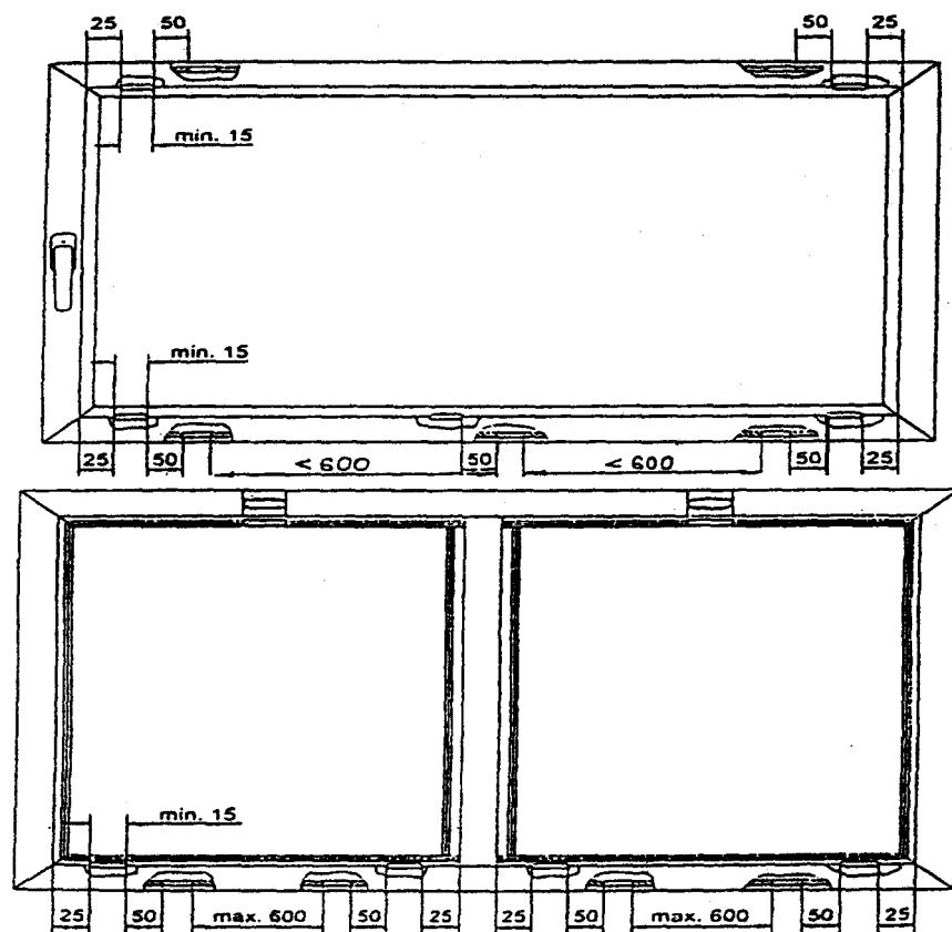
Рисунок В.2 — Расположение функциональных отверстий
